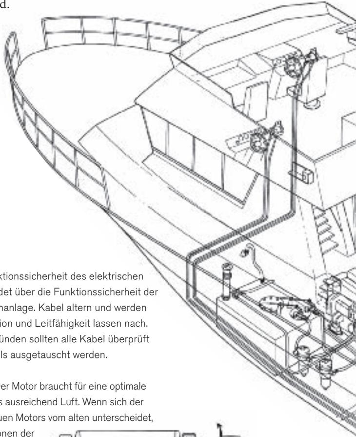
**Elektrik.** Die Funktionssicherheit des elektrischen Systems entscheidet über die Funktionssicherheit der gesamten Motorenanlage. Kabel altern und werden brüchig. Die Isolation und Leitfähigkeit lassen nach. Aus Sicherheitsgründen sollten alle Kabel überprüft und gegebenenfalls ausgetauscht werden.
