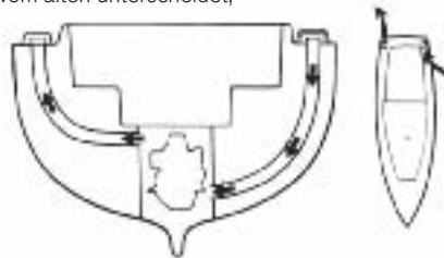
**Kraftstoff.** Die Versorgung des Motors mit sauberem Kraftstoff ist unerlässlich. Das Kraftstoffsystem muss gründlich überprüft werden, besonders auf Leckagen, denn Kraftstoff, vor allem Benzin, ist sehr feuergefährlich. Wird ein Benzinmotor durch einen Diesel ersetzt, müssen Tank und Kraftstoffzuführungen umgebaut werden.
